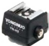
Используется для установки на камеры Sony Alpha и Minolta Dynax, имеющих свой, нестандартный горячий башмак. Он позволяет использовать с камерами Sony Alpha и Minolta Dynax фото-аксессуары (радио-, ИК- синхронизаторы, вспышки и др.) имеющие посадочную платформу для стандартного башмака. На переходнике имеется разъем для подключения кабеля с PC-разъемом.
